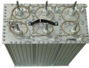
**Duplexer SINCLAIR 6 Cavidades 138-174 MHz 85 dB de Aislamiento 500 kHz de Separación en Tx-Rx Montaje-Rack 350 Watt N Hembra Q2330-E**
