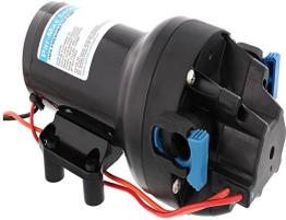
**Bomba controlada por presión Par Max para trabajo pesado a 12 Vcd caudal de 5 GPM presión máxima 40 psi para manguera de entrada con orificio de 38 mm 1½ manguera de descarga con orificio de 25 mm 1 P501J-115S-3A**
