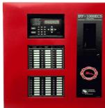
**Panel de Detección de Incendio con Tecnología Analógica Direccional que Integra un Sistema de Evacuación de Voz. 127 puntos SD por lazo o 198 puntos IDP por lazo (99 detectores/99 módulos)**
