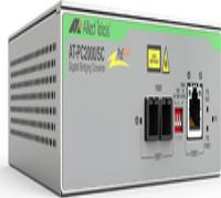
**Convertidor de medios Gigabit Ethernet PoE a fibra óptica conector SC multimodo MMF distancia hasta 550 m AT-PC2000/SC-90**
