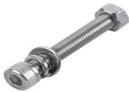
**1 Tornillo Allen Milimétrico de Acero Inoxidable M8-125 x 30/ Con 1 Tuerca 1 Arandela de Presión y 1 Plana / Para Montajes de Módulos Foto Voltaicos 950-5080-304**
