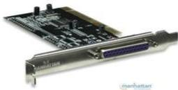
**Tarjetas PCI MANHATTAN 158220 158220 Tarjeta PCI Con Puerto Paralelo. Soporta Modos De Operación EPP ECP Y SPP.**
