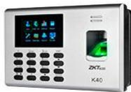
**CONTROL DE ACCESO Y ASISTENCIA SIMPLE ZKTECO K40 / 1000 HUELLAS / TCPIP / DESCARGA DE USB EN HOJA DE CÁLCULO / 2 HORAS DE RESPALDO / COMPATIBLE CON TIME NET LITE GRATUITO**
