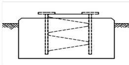
**Anclaje tipo Base Corta para Sección SSV5N Incluida en torres SS050HD90K y SS040HD90K SSVSB5**
