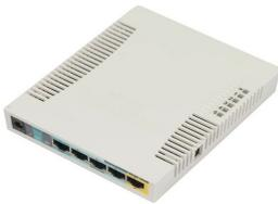
**Routerboard 5 Puertos Fast 1 Puerto Usb Wifi 24 Ghz 80211 BGN Gran Cobertura Con Antena 25 Dbi Hasta 1 Watt De Potencia RB951UI-2HND**
