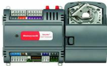
**Spyder Micro Bacnet Para Vav Con Sensor De Pd Y Actuador Incluido 4 Ui 2Ao 2Do 24 Vac PVB4022AS/U**
