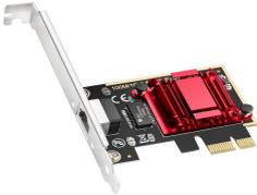
**Adaptador Cudy PE25 PCI Express 1 puerto RJ45 hasta 2.5Gbps chipset RTL8125 soporte Wake-On-LAN UPC 6971690791483**
