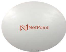
**Antena Direccional / 4 ft / 5.9-7 GHz / Ganancia 36 dBi / SLANT de 45 y 90 / Ideal para radios C060940C121C / Incluye Jumpers con conector N-Macho a RPSMA / montaje y radomo incluido. NP64**
