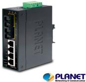
**SWITCH INDUSTRIAL ADMINISTRABLE / PLANET ISW-621 / 4 PUERTOS RJ45 CON VELOCIDADES DE 10/100 MBPS / 2 PUERTOS FX 100/1000 MBPS / 089 MPPS/ 12 48V CC / 12W DE CONSUMO / MONTAJE EN PARED / RECINTO DE METAL**
