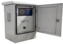
**Controlador de Señales de Tráfico / ARM9 32 bits / Diseño Modular / 44 Salidas de Luz Independientes / Ethernet / RS-232 y RS-485 / Entrada para Botón Peatonal / IP54 DS-TSC300-44H/HK3**
