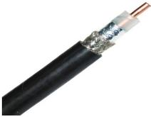
**Retazo de 1 Metro de Cable coaxial tipo RG-8/U conductor central de 274 mm en cobre sólido cal 10 con 90 de blindaje de malla trenzada de cobre estañada cinta Duobond aislamiento de polietileno semi-sólido forro de PVC PRE 9913\*1MTS**
