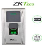
**ZK MA300 - LECTOR BIOMETRICO CON APERTURA DE PUERTA / 1500 HUELLAS / 10000 TARJETAS ID / 100000 REGISTROS / IP54 UPC**
